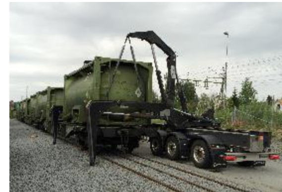
Транспортування до залізничних вагонів. Не вимагає підготовки ґрунту для роботи.
