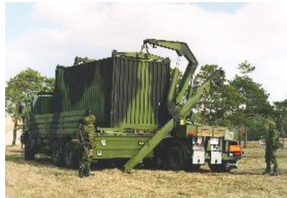
Верхній розкид контейнера дозволяє обробляти контейнери у верхніх кутових завісах.
