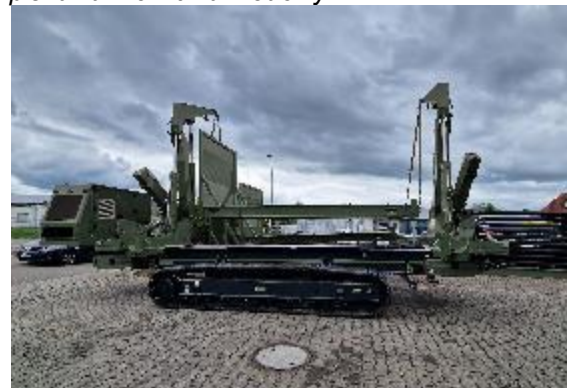
Можна встановити боковий навантажувач на гусеничний хід для роботи на бездоріжжі
