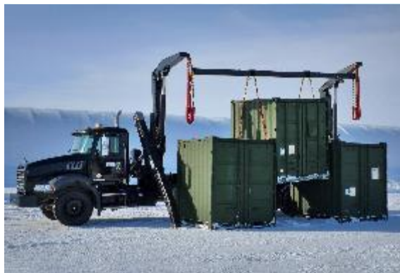
Підйомна балка, яка дозволяє переміщати вантажі меншого розміру або вантажі з різними точками підйому
