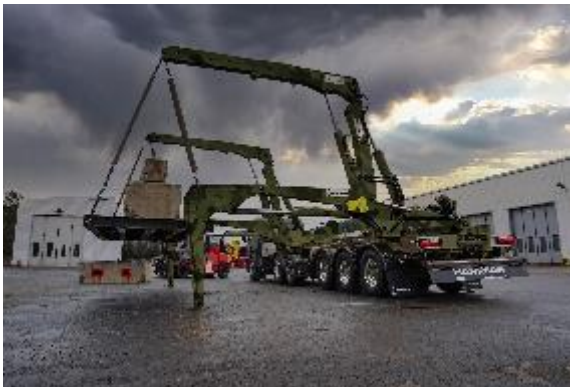
Висувні крани дозволяють перевантажувати вантажі далі від шасі
